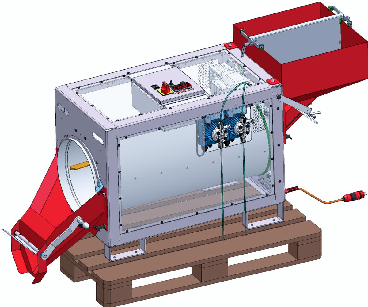
Saatgut-Behandlungstrommel mit **zwei** Membranpumpen (je 7 - 18 l/h) zur Beimischung von unterschiedlichen Saatgutarten, mit im ökologischen- und konventionellen Landbau zugelassenen dünnflüssigen Nährstoff- und Bakterienlösungen, die mit einer Nebeldüse auf das zu behandelnde Saatgut gesprüht werden. Diese Variante wird eingesetzt wenn die Behandlungslösungen nicht vorab gemischt werden dürfen. Beide Pumpen sind unabhängig voneinander schalt- und einstellbar.
