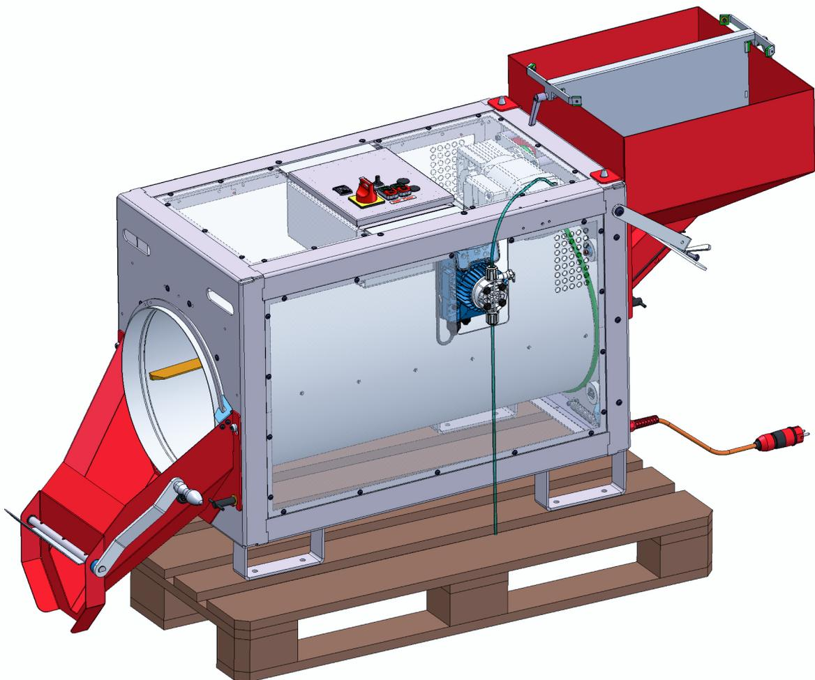
Saatgut-Behandlungstrommel mit **einer** Membranpumpe (7 - 18 l/h) zur Beimischung von unterschiedlichen Saatgutarten, mit im ökologischen- und konventionellen Landbau zugelassenen dünnflüssigen Nährstoff- und Bakterienlösungen, die mit einer Nebeldüse auf das zu behandelnde Saatgut gesprüht werden.
